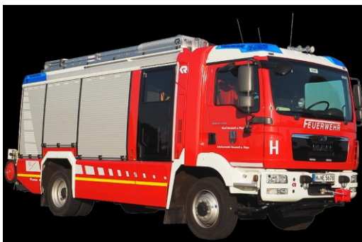
Abbildung 18: HLF 20 mit MaZE nach DIN 14 530-27
