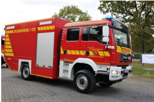
Abbildung 20: GW L 2 nach DIN 14 555-22
