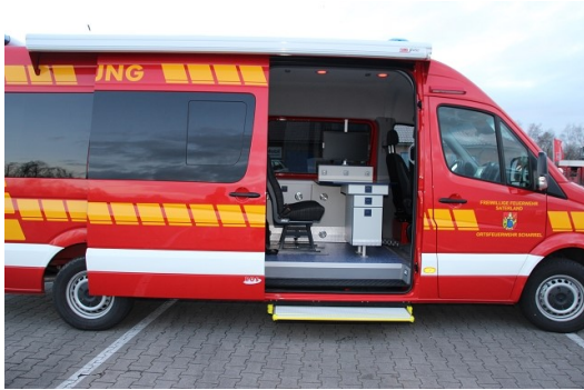
Abbildung 17: ELW 1 nach DIN 14507-2
